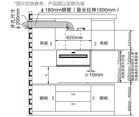
吸油烟机的出风口到排气孔的距离不宜太长，以小于1.5m为宜，且转弯数量不应多于2个。在确保箱体的安装高度前提下，烟机下沿与台面的距离A的范围为250mm~300mm。如与橱柜配合，箱体顶部与炉灶上烹饪器具的支撑面之间的推荐竖直距离为695mm。可根据用户身高和要求调整安装高度，但不建议超过推荐高度范围。
